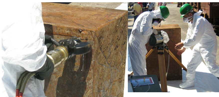
Caratterizzazione cassaforte con analizzatore multicanale HPGe portatile (ARPA FVG)
